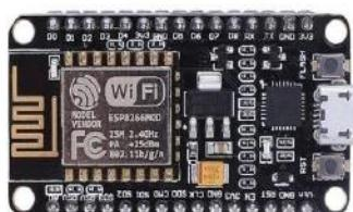
Gambar 2.3. NodeMCU ESP8266
