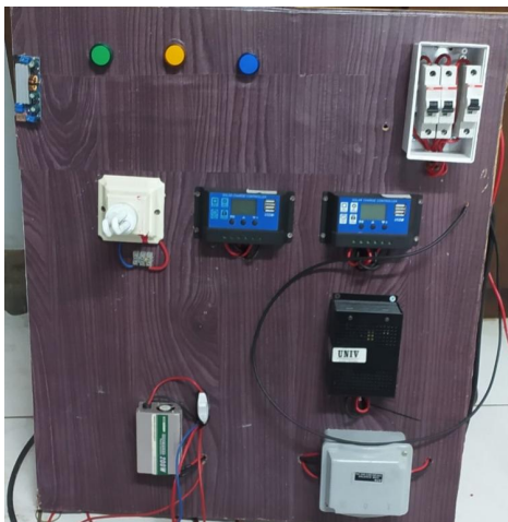
Gambar 4 Panel Simulator Pembangkit Listrik Tenaga Hybrid
