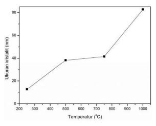
**Gambar 4**. Hubungan temperatur kalsinasi nanopartikel SnO<sub>2</sub> dengan ukuran kristalit
