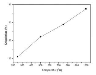
**Gambar 5**. Hubungan temperatur kalsinasi nanopartikel SnO<sub>2</sub> dengan kristalinitas
