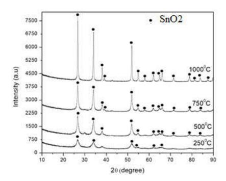
**Gambar 3.** Pola analisis XRD nanopartikel SnO<sub>2</sub> berdasarkan variasi temperatur kalsinasi.
