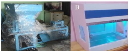
Gambar 1 Alat press baglog (A) dan laminar air flow (B) untuk pembuatan baglog jamur tiram putih
