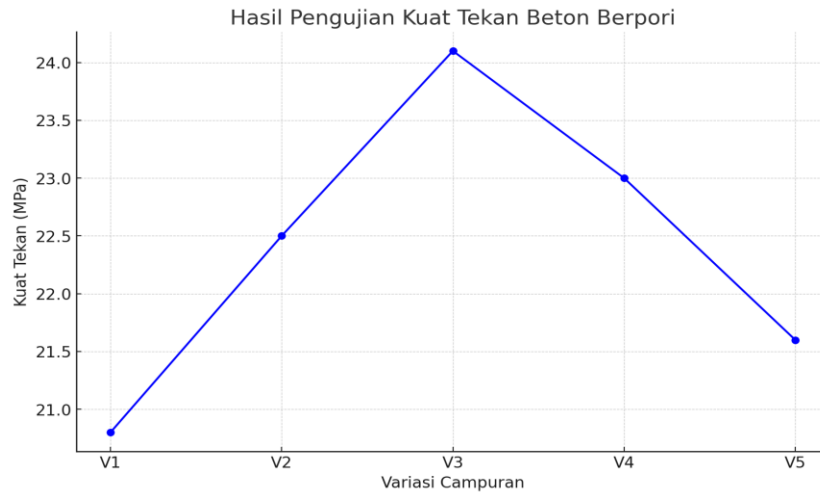
Gambar 3. Pengujian Kuat Tekan Beton Pori
