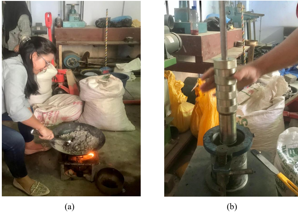
Gambar 1. Proses Pembuatan Benda Uji Beton Aspal (a) dan Penumbukkan 75 kali didalam Mold (b).
