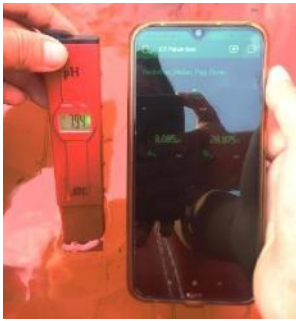
Gambar 12. Pengkalibrasian pH Meter (ATC) Dengan Sensor pH (SEN0161 – V2) Melalui Aplikasi Blynk
