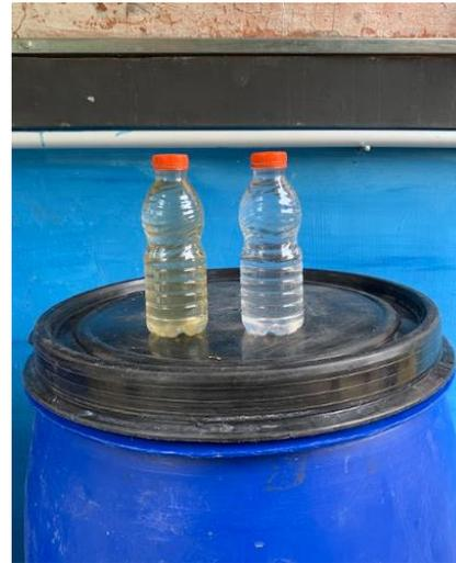
**Gambar 5. Air sebelum pengolahan menggunakan SSF (kiri) dan air sesudah pengolahan menggunakan SSF (kanan)**
