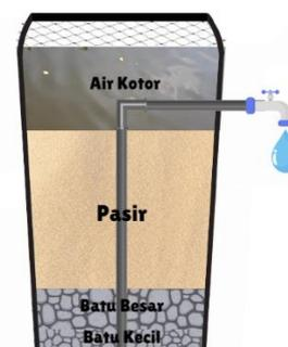
**Gambar 3. Skema sederhana rangkaian alat SSF**
